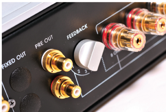
这部胆机最大的特色是分别在 8 欧姆负载与 4 欧姆负载时负反馈各有三段（每级 1dB）调整
