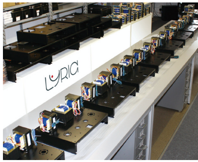
生产线上的产品可以看出使用巨大 EI 变压器
