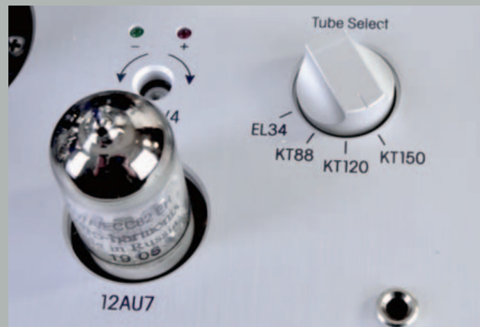
Über einen Drehschalter lässt sich der Typ der eingesetzten Endröhre anwählen. Danach muss zwingend der Ruhestrom eingestellt werden.
